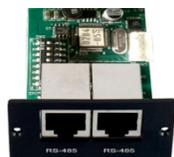
Коммуникационная карта MBUS Card-711 предназначена для обеспечения связи источника бесперебойного питания с ПК по протоколу MODBUS:
