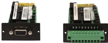
Коммуникационная карта RELAY Card-711 обеспечивает возможность удаленного мониторинга и дистанционного включения и отключения ИБП. Реле карты могут работать как в нормально открытом (НО), так и в нормально закрытом (НЗ) режимах. Выбор режима осуществляется установкой переключателей на плате в нужное положение для каждого реле. Карта совместима с серверами, персональными компьютерами и оборудованием для рабочих станций.
